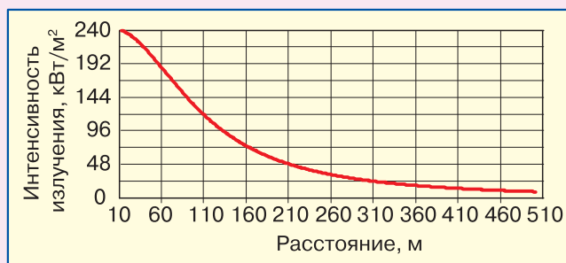
Рис. 4. Зависимость интенсивности теплового излучения огненного шара от расстояния
