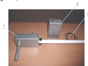
Рис. Мобильная система мониторинга геодинамической активности «Пошук-1»: 1 – измерительный блок; 2 – блок преобразования частоты; 3 – кабель
