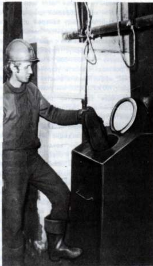
Рис. 2. Устройство для обеспыливания спецодежды (шахта «Гигант-Глубокая» рудоуправления им. Дзержинского)
