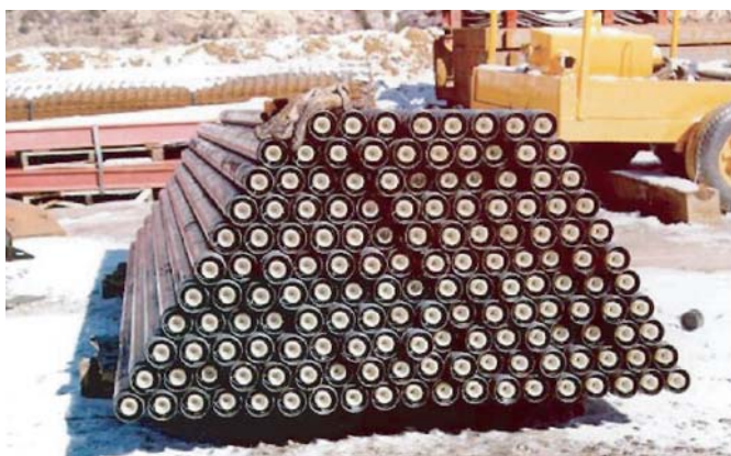
Рис. 4. Буровая штанга со вставленной в нее системой DGS MECCA
