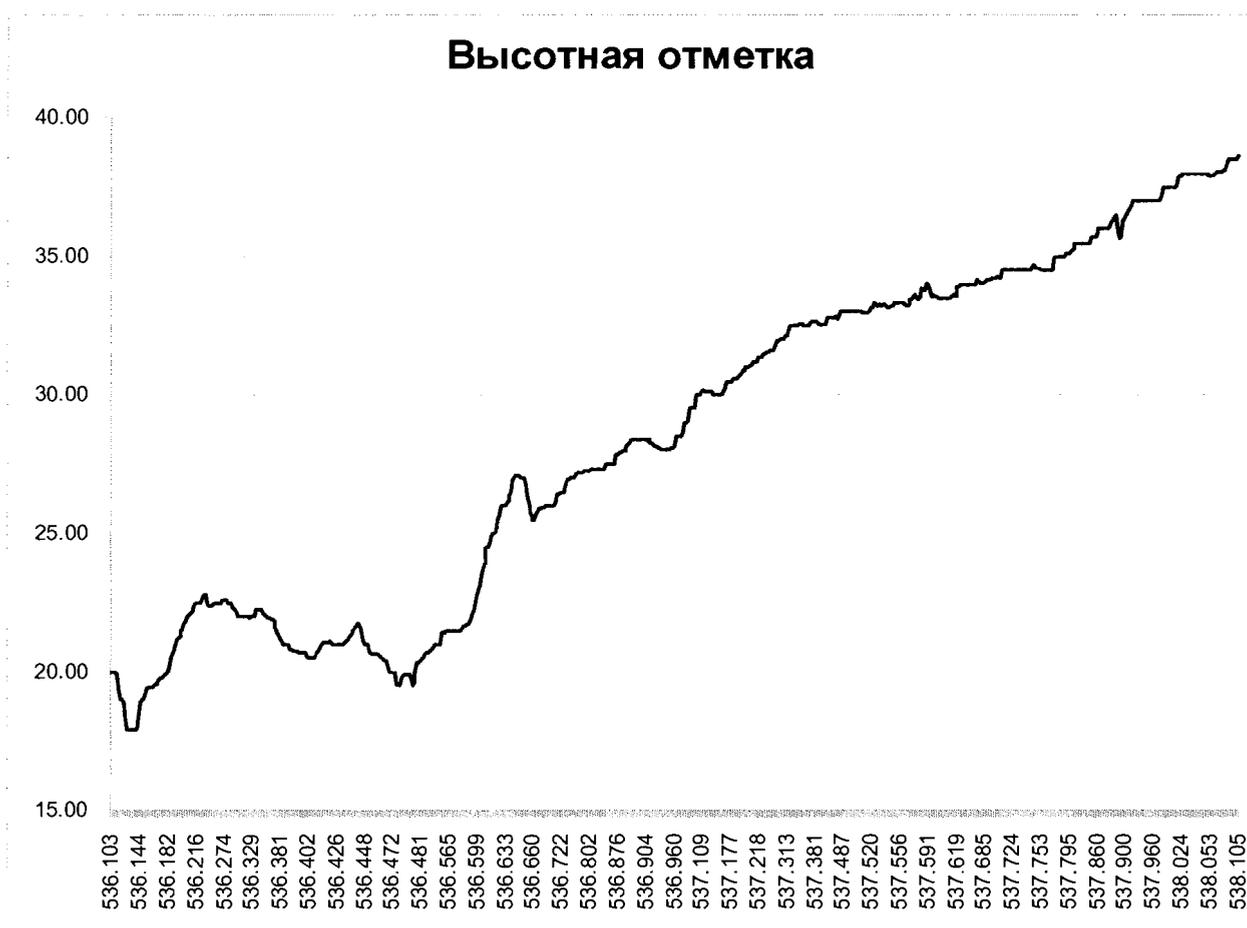
Рис.1 – Фрагмент профиля трассы нефтепровода 24”
